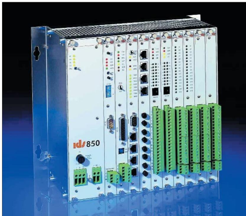
Die IDS-Rundsteuerzentrale 850 ist ein autarker Rechner und kann den gesamten zyklischen, zeitgesteuerten Betrieb einer Rundsteueranlage unabhängig von einem übergeordneten Rechner führen
